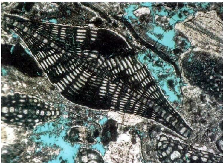
泥晶生物碎屑灰岩，货币虫、有孔虫、棘皮碎屑，粒间溶孔
