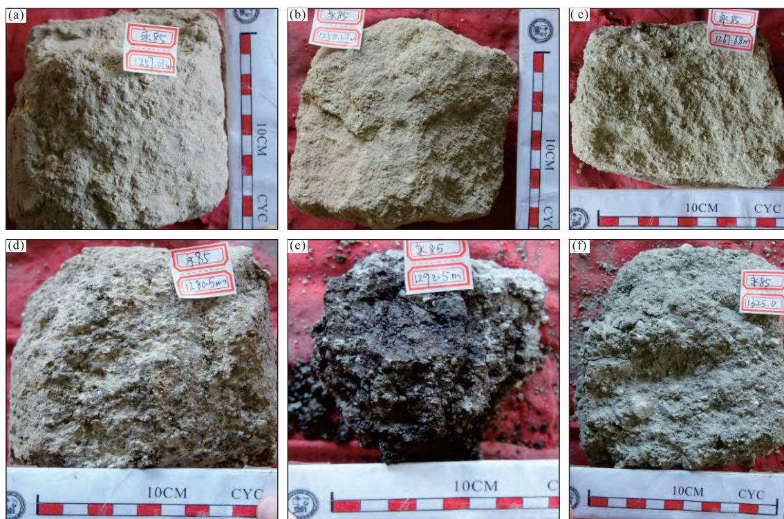
(a)土黄色含砾砂岩, 1257.01 m, 粘土含量高; (b)土黄色含砾砂岩, 1258.47 m, 油味; (c)土黄色含砾砂岩, 1267.68 m, 含油; (d)砾质砂岩, 1280.5 m, 含油; (e)砾质砂岩, 1292.5 m, 含油; (f)细砾岩, 1325.0 m, 不含油
