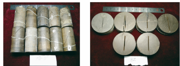
图 2 断裂韧性实验前后的样品试件
