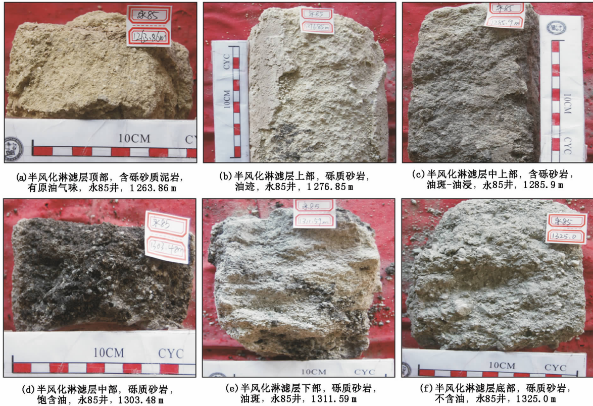
图2 永北鼻状构造带不整合结构岩心特征
