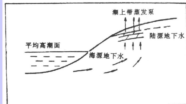
图 16-10 潮上萨巴哈蒸发泵白云石化机理
