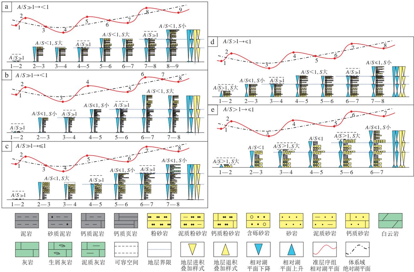
图5 东营凹陷南坡东段沙四上亚段低位体系域层序动态演化过程
