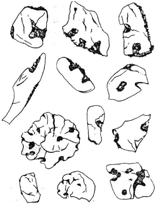
石英晶屑 表面光洁，具不规则裂缝及港湾状熔蚀外形
